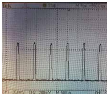
Bei 15,5 %: Wechsellicht mit 1,24 kHz,
